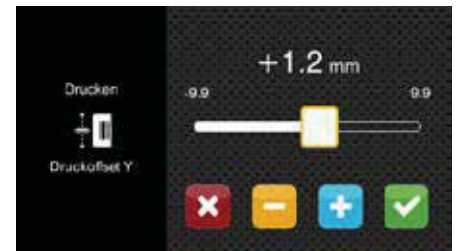
调整标签打印定位 Y 使用滑杆快速调整， 使用 ± 按键精准调整
